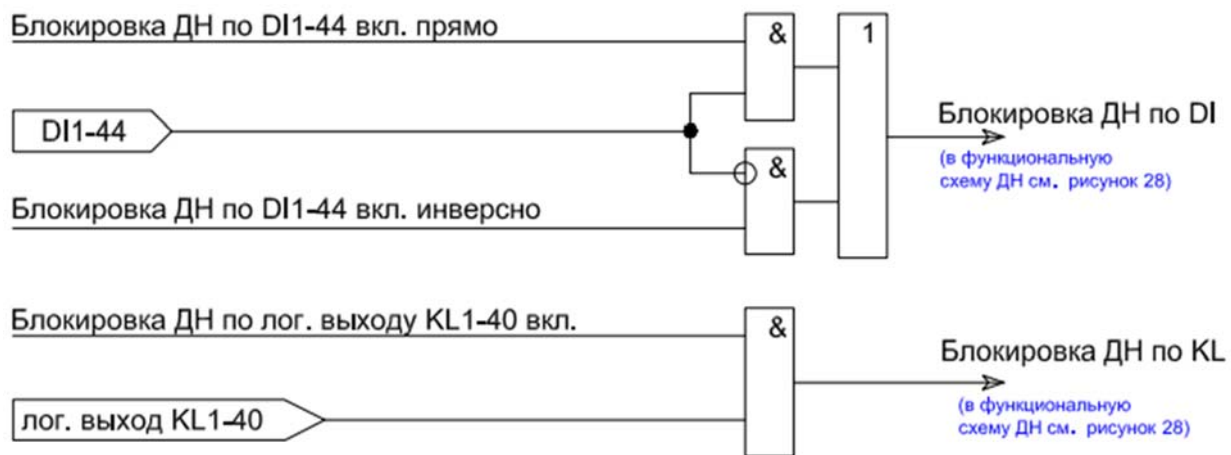
Рисунок 29 – Алгоритм формирования сигналов блокировки ДН по дискретным входам и логическим выходам реле
