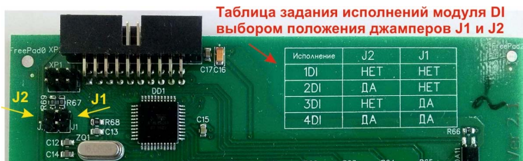
Рисунок 7 – Таблица задания исполнений модуля DI и места установки джамперов J1 и J2
