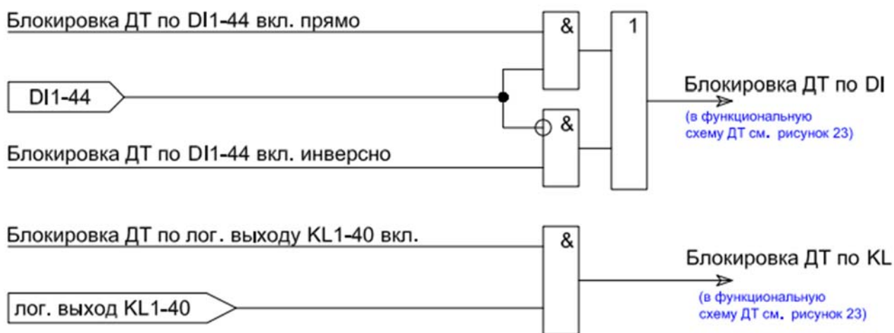
Рисунок 24 – Алгоритм формирования сигналов блокировки (ускорения) ОБР по дискретным входам и логическим выходам реле
