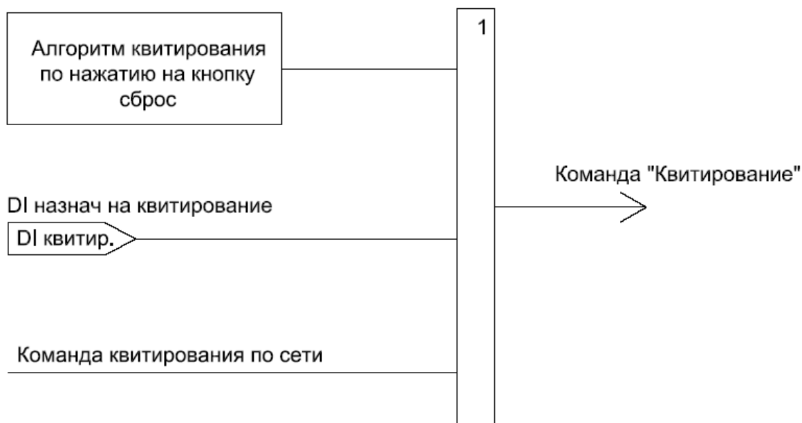
Рисунок 64 – Алгоритм работы функции квитирования
