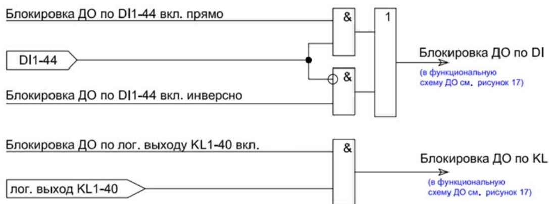
Рисунок 18 – Алгоритм формирования сигналов блокировки (ускорения) ОБР по дискретным входам и логическим выходам реле
