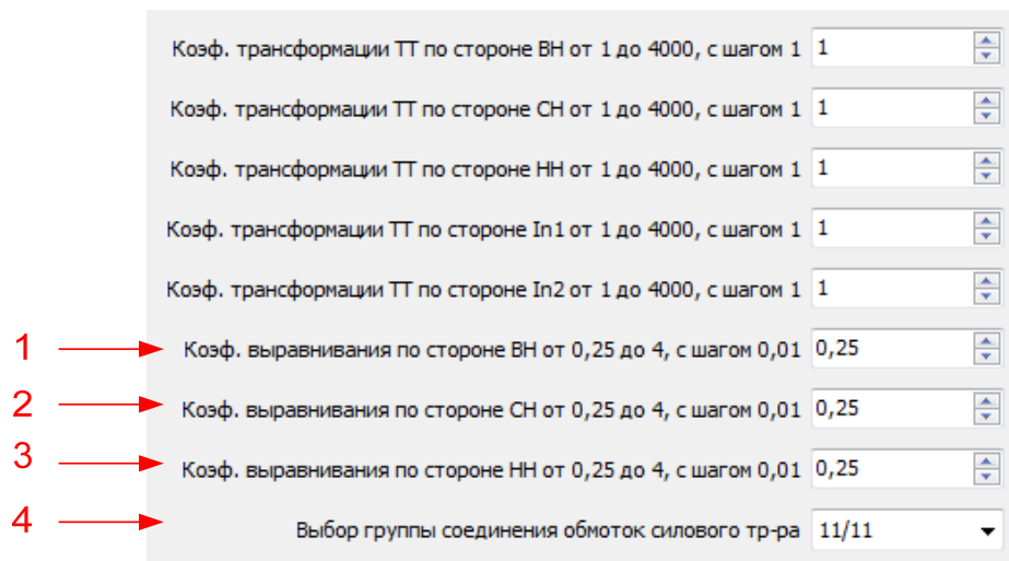
Рисунок 16 – Выбор параметров дифзащиты в окне программы «BURZA»
