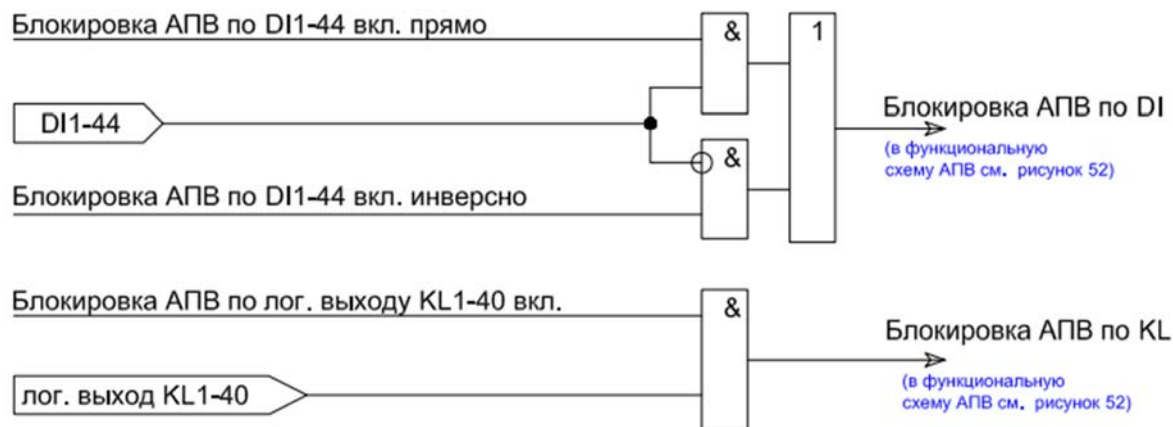
Рисунок 51 – Алгоритм формирования сигналов блокировки АПВ по дискретным входам и логическим выходам реле
